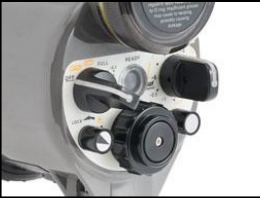
Large 「Main Mode Switch」 , 「EV Control Switch」
